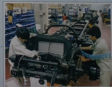
Dây chuyền lắp ráp động cơ và cabin xe tải 3,5 tấn tại công ty Hyundai - TP. Hồ Chí Minh
